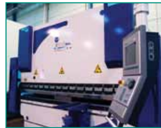
ITALTEC press brake, 160 ton/3m.
